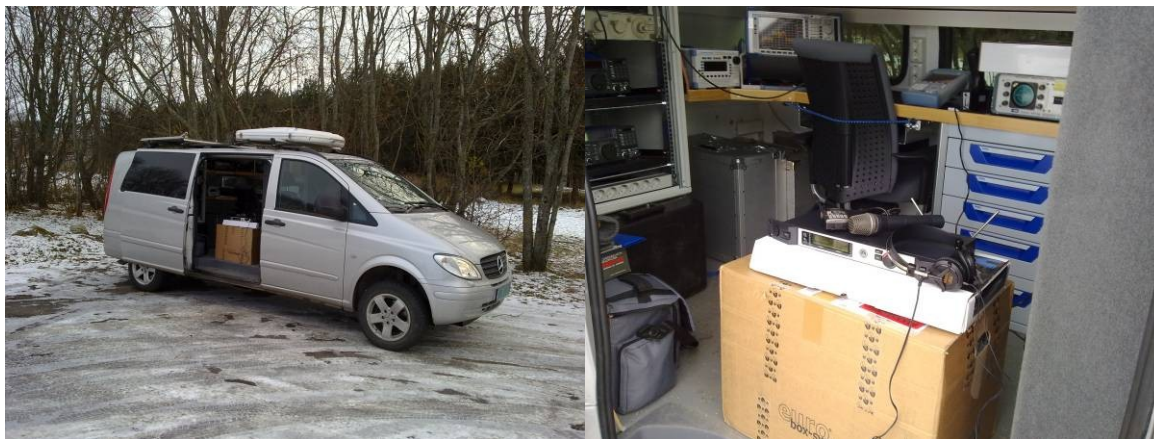
Bildene viser situasjon ved test av trådløst mikrofonsystem utsatt for interferens fra et relativt kraftig DVB-T signal.
